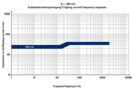
Diagramme Fehlerstromschutzschalter DFS 4 025-4/0,30-B+
