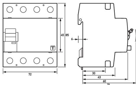
Maßzeichnung Fehlerstromschutzschalter DFS 4 025-4/0,30-B+
