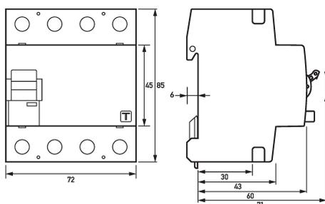
Maßzeichnung Fehlerstromschutzschalter DFS 4 040-4/0,30-A V500
