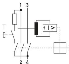
Schaltungsbeispiel Fehlerstromschutzschalter DFS 2 063-2/0,50-A KV
