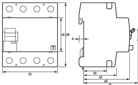
Maßzeichnung Fehlerstromschutzschalter DFS 4 025-4/0,30-B+ HD
