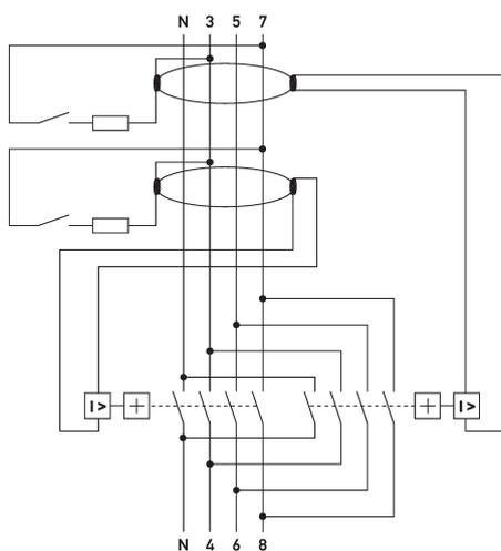
Schaltungsbeispiel Fehlerstromschutzschalter DFS 4 063-4/0,30-A KV Twin
