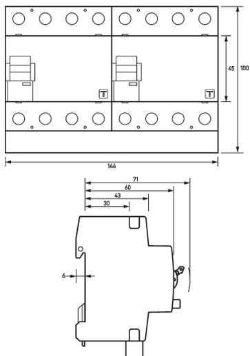
Maßzeichnung Fehlerstromschutzschalter DFS 4 063-4/0,30-A KV Twin
