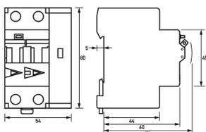
Maßzeichnung Fehlerlichtbogen-Schutzeinrichtungen DAFDD 1 B25/0,03/2-A
