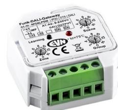
Das Funk-DALI Gateway mit manueller Gruppen-/Szenen-/Zoneneinstellung kann mit verschiedenen Funk-Dimmer-Steuerelementen mit 868 MHz, aber auch über einen Taster (8V bis 230V/AC/DC) angesteuert werden. Somit können unterschiedliche DALI-Steuerungen für Unicoloranwendungen bequem über Funk gesteuert werden. Die Stromversorgung des Gateways erfolgt über den DALI-BUS. Die Maße sind: LxBxH: 45m x 46mm x 22mm, Protokoll: DT6.
