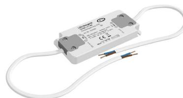
Das LED-Netzgerät lässt sich auf Grund der kleinen Bauform auch bei eingeschränkten Platzverhältnissen am Montageort verwenden und besitzt außerdem die Kennzeichnung F. Die Anschlussleitungen haben eine Länge von 20cm primärseitig und 20cm sekundärseitig. Technische Daten: Versorgungsspannung: 220-240V/AC, ta: -20°C - 50°C, tc: 80°C, Powerfaktor: 0,55.
