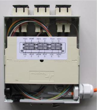
Kassettendeckel aufrasten und die offenen Gehäuseeinführungen mit Hilfe der Blindstopfen verschließen.
