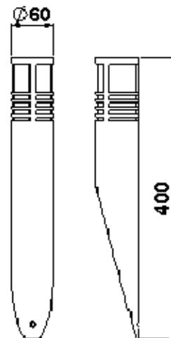
**Montage:** Für die Installation und für den Betrieb dieser Leuchte sind die nationalen und internationalen elektronischen Sicherheitsvorschriften zu beachten. Anschlußbügel mit Hilfe der 2 Schrauben an der Wand befestigen. Klemmenabdeckung entfernen, Schutzleiterverbindung und elektrischen Anschluß an der Klemme herstellen. Edelstahlrohr über den Anschlußbügel schieben und mit 1 Schraube fixieren.
