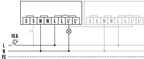
Standardbetrieb mit optionaler Ansteuerung durch Schließaster und Parallelschaltung von max. 10 Geräten
