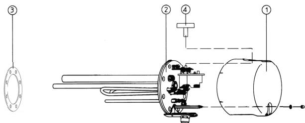
**Passende Kesselfansche:** für alle Typen 180 Ø, TK 150
