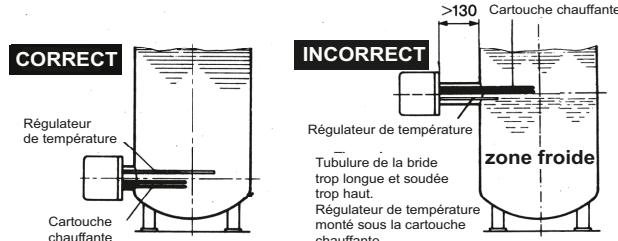
La longueur de la tubulure de la bride ne doit pas dépasser 110 mm max. pour que la sonde de température et la cartouche chauffante elle-même puissent pénétrer suffisamment loin dans le réservoir.
