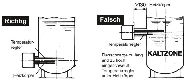
Die Flanschzarge darf nicht länger als max. 110 mm sein, damit Temperaturfühler und Heizkörper noch ausreichend in den Kessel ragen.
