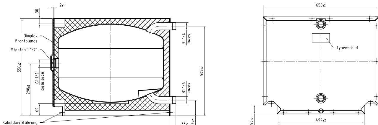
**Abmessungen Unterstell-Pufferspeicher PSP 140E**
