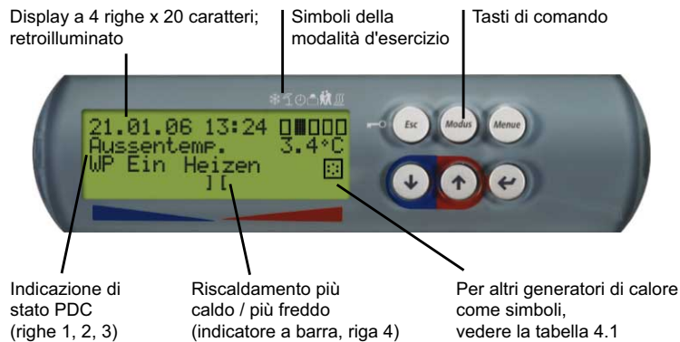
Fig. 4.2: Programmatore della pompa di calore con schermo standard a display LCD integrato con tasti di comando
