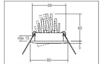
LED-RGB-Einbaustrahler, nickel matt, rund. Ausgeführt in kompakter Bauform für werkzeuglose Schnellmontage zum Deckeneinbau. Anschlussleitung: 4-adrig, Montage in Hohldecken mit Federbefestigung.
