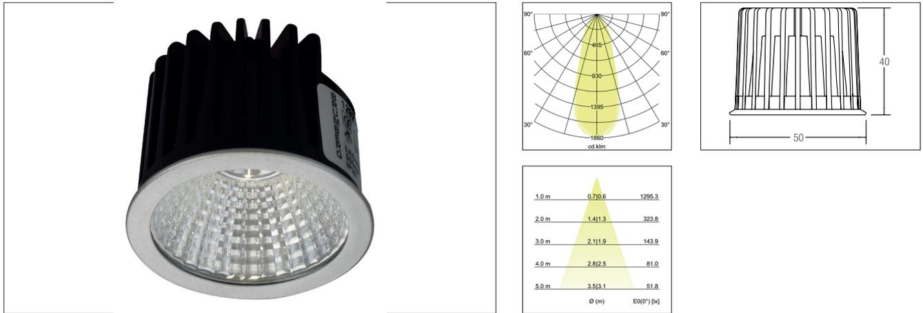
LED-Reflektoreinsatz MR16, 6 W, rund. Ausführung: Plug&Play, Material: Aluminium / Glas, Schutzart: nach DIN EN 60529: IP20, Schutzklasse: (EN 61140) III, Leistung: 6W, Lichtstrom: 680lm, Farbtemperatur: 2700 K, Abstrahlwinkel: 38°.
