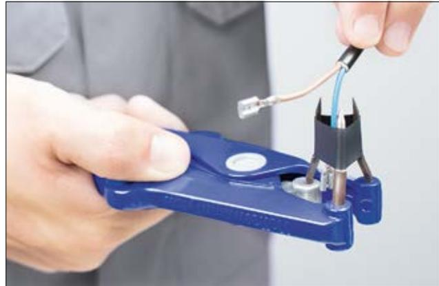
Einfache und sichere Montage von Tüllen und Schläuchen durch die Dreidornzangen K, S und SS.
