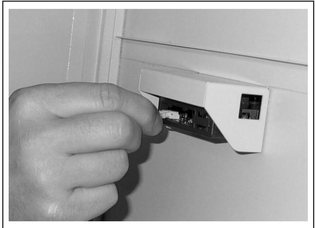
Abb. 13: Anschlusskabel Display anschließen
