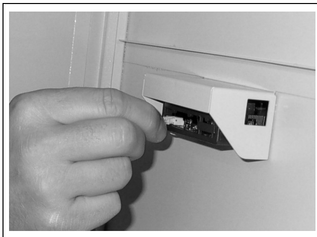
Fig. 13 : brancher le câble de raccordement de l'afficheur
