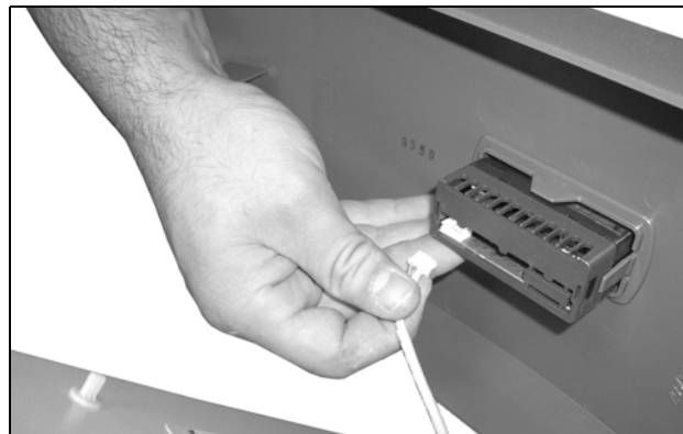
Fig. 60: Estrarre il cavo del display
