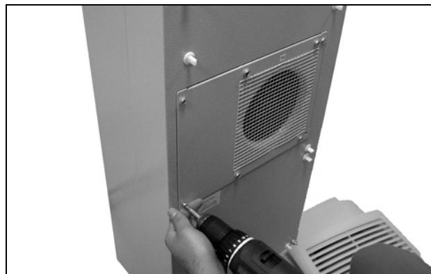
Fig. 63: Allentare le quattro viti del ventilatore del circuito esterno
