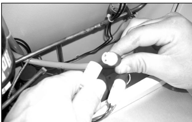
Fig. 67: Scollegare i connettori del ventilatore (3)
