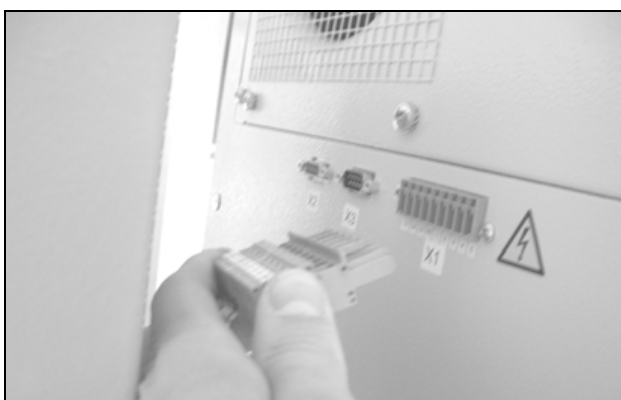
Fig. 34: Estrarre il connettore di alimentazione
