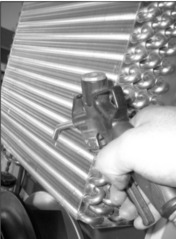
Fig. 51: Soffiare aria compressa sui tubi dello scambiatore di calore e nel vano compressore (1)
