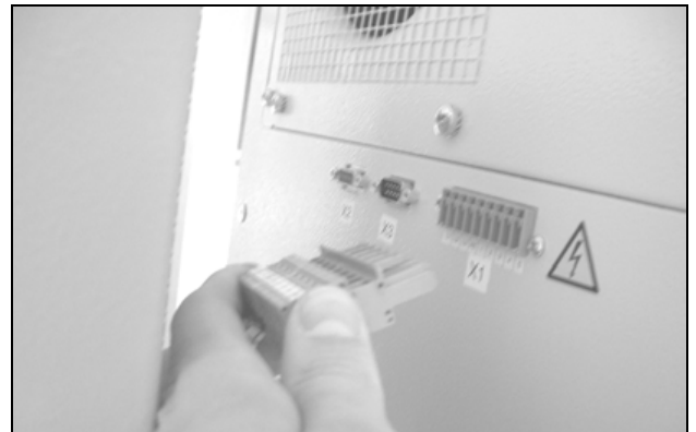
Fig. 53: Estrarre il connettore di alimentazione
