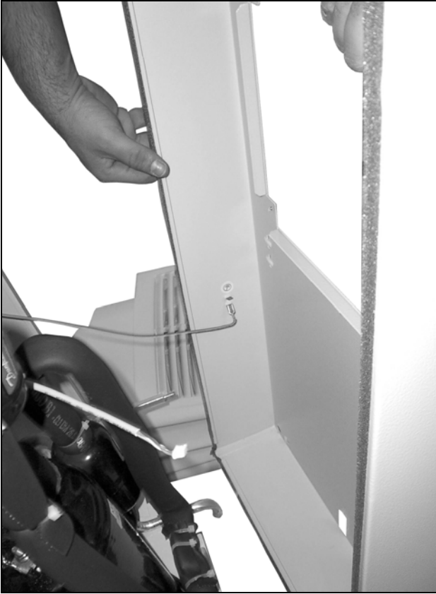
Bild 72: Dra ut jordkabeln (1)
