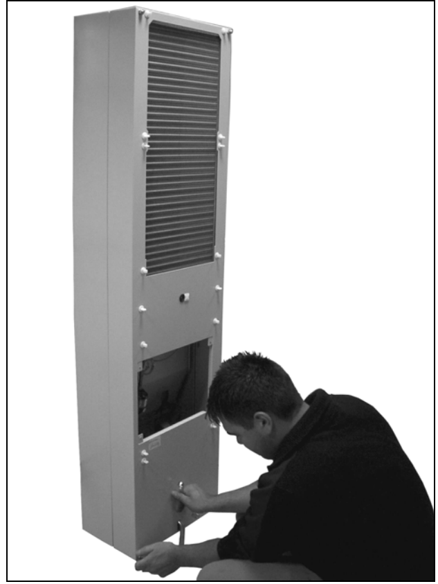
Bild 70: Lossa fyra muttrar på höljet
