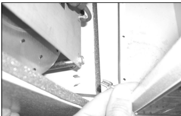
Bild 50: Lossa jordkabeln mellan höljet och chassit (2)
