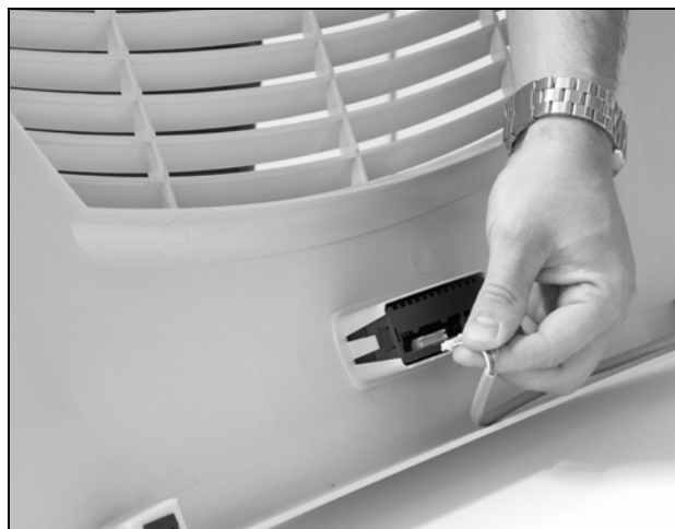
Fig. 24: Estrarre il connettore del display
