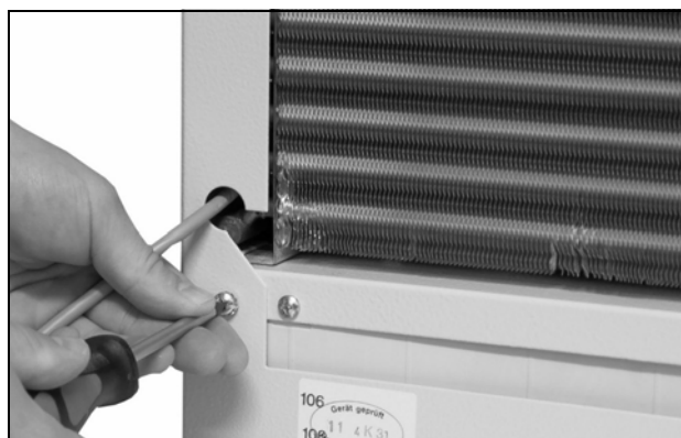
Fig. 26: Rimuovere le viti di fissaggio della cuffia (allentare quattro viti)
