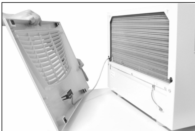
Fig. 23: Rimuovere la griglia di aerazione
