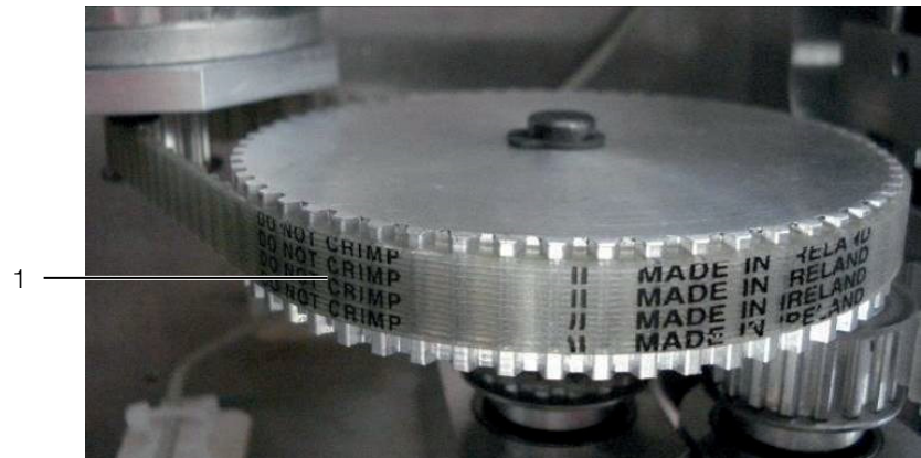
Obr. 9: Sejmutí ozubeného řemenu
