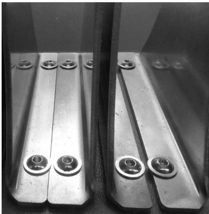
Fig. 5: Porta-bobina (lunghezza 8 mm: a sinistra, lunghezza 10 mm: a destra)
