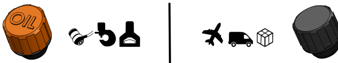
Εικ. 3: Αντικατάσταση της βιδωτής τάπας ή αντίστοιχα της βίδας αερισμού (ενδεικτική απεικόνιση)
