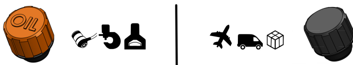
Sl. 3: Zamjena navojnog čepa odnosno vijka za ventiliranje (prikaz služi za ilustraciju)
