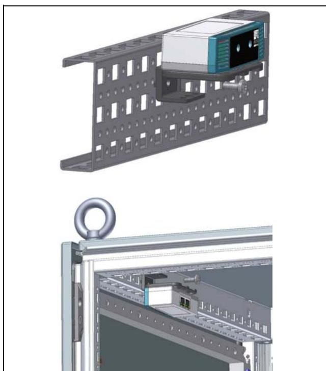
Рис. 4: Крепление датчика в шкафу или IT-стойке
