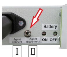
Fig. 27: Interruttore di bloccaggio
