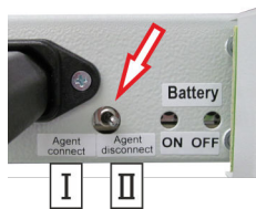
Fig. 19: Interruttore di bloccaggio
