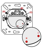
Potentiometer (A): Potentiometer für Helligkeitswert Potentiometer (B): Potentiometer für Akustiksensor Potentiometer (C): Potentiometer für Nachlaufzeit
