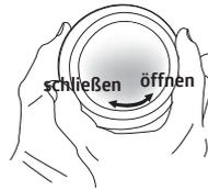
Vor der Montage muss die Linse entfernt werden. Dazu ist die Linse um ca. 5° entgegen dem Uhrzeigersinn zu drehen und abzunehmen.
