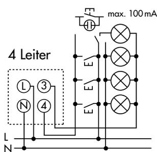
Auch zum Anschluss des B.E.G. LUXOMAT® Indoor 180-TR geeignet. Erweiterung des Erfassungsbereichs mit maximal 10 Meldern möglich.
