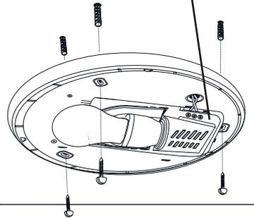
Öffnen Sie die Lampe, indem Sie das Glas mit einer leichten Drehung im Gegenuhrzeigersinn lösen. Führen Sie das Netzkabel auf der Rückseite der Lampe durch die Gummidurchführung. Bohrlöcher an der Decke oder Wand anzeichnen. Passende Löcher bohren und die Dübel fest in die Bohrungen eindrücken. Die Lampe anschrauben.
