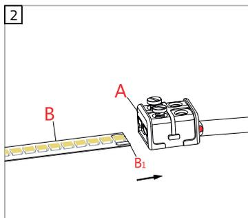
2. Nehmen Sie den LED-Strip (B) und führen Sie diesen mit dem Ende (B1) bis zum Anschlag in den Einspeisungs- oder Flexverbinder auf der dafür vorgesehenen Seite (A).
