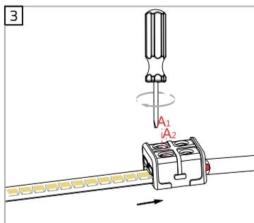
3. Ziehen Sie die Schrauben (A1, A2) wieder mit einem passenden Schraubendreher fest.
