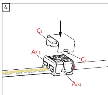
4. Anschließend kann der Einspeisungs- oder Flexverbinder mit dem beiliegenden Deckel versehen werden. Drücken Sie dazu den Deckel, wie in Bild 4 zu sehen, von oben auf den Einspeisungsverbinder, bis die zwei Nasen (A2-1, A2-2) in die dafür vorgesehenen Aussparungen (C1, C2) einrasten.
