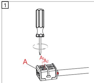
1. Lösen Sie die Schrauben (A1, A2) auf der Seite, welche für den LED-Strip vorgesehen ist (A), mit einem passenden Schraubendreher.
