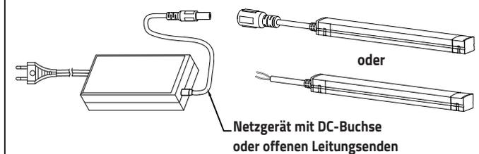
Netzgerät mit DC-Buchse oder offenen Leitungsenden
