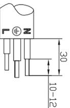
Geeignet für Leiterquerschnitt 1-1,5mm<sup>2</sup>
