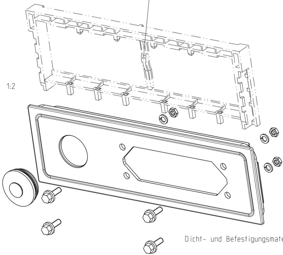
Dicht- und Befestigungsmaterial im Polybeutel beiliegend
