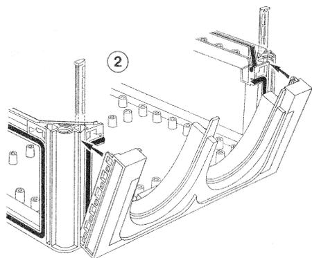
2. Kabeleinführung einsetzen und mit Flanschverbindern sichern.
