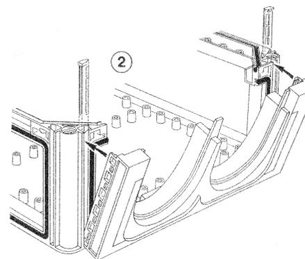
2. Kabeleinführung einsetzen und mit Flanschverbindern sichern.
