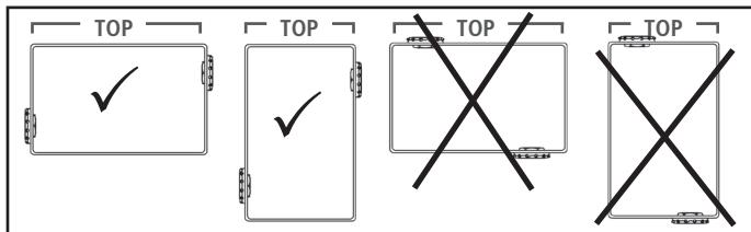
Mindestens zwei Belüftungselemente pro Gehäuse
