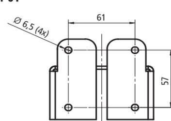
Die Türhaftmagnete und die Ankerplatten können sowohl in der Konsole als auch außen auf der Konsole montiert werden.
