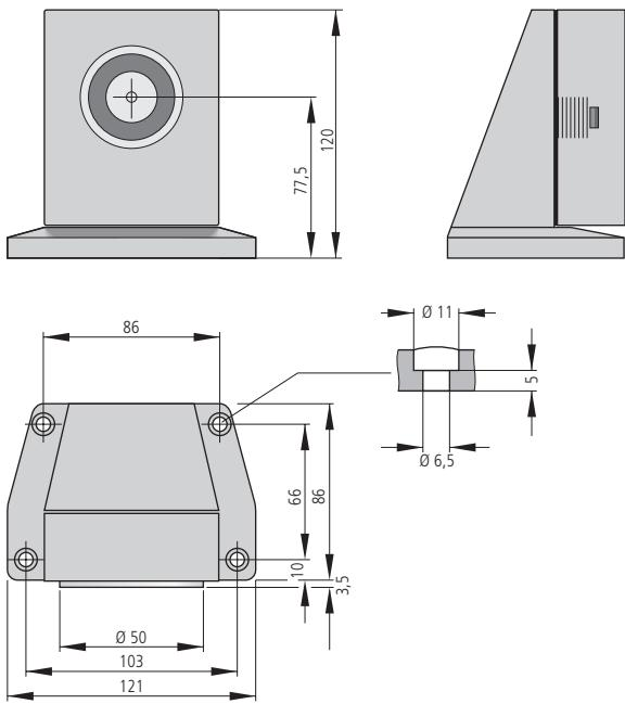
Standardanker/Induit standard/standard doorplate ASS 55
