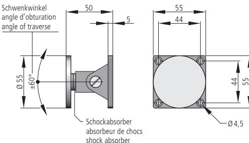
Teleskopanker/Induit télescopique/telescopic doorplate ATS 55
