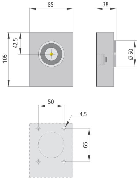
**Standardanker/Induit standard/standard doorplate ASS 55**
