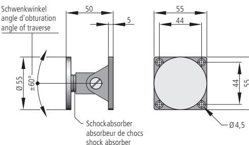
**Teleskopanker/Induit télescopique/telescopic doorplate ATS 55**
