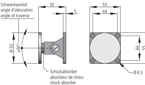
**Teleskopanker/Induit télescopique/telescopic doorplate ATS 55**
