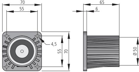
**Standardanker/Induit standard/standard doorplate ASS 55**
