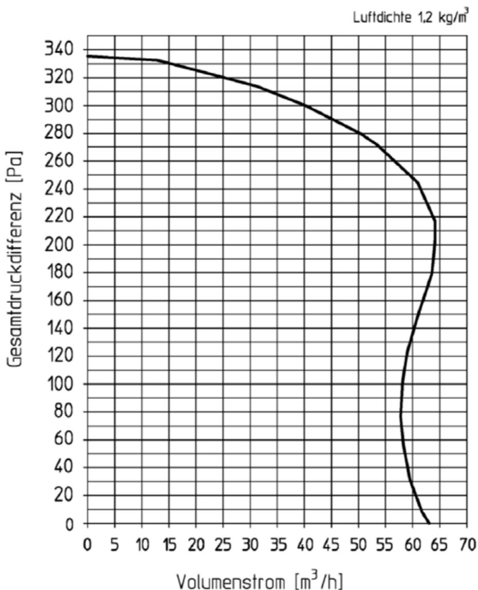
Einzelentlüftungsgeräte der Serie ER-UPB und ER-UPD zur Verwendung in Einzelentlüftungsanlagen mit gemeinsamer Abluftleitung nach DIN 18017-3
