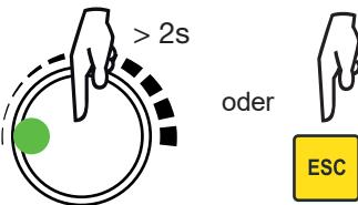
Abbrechen einer Einstellung durch langes Drücken des Drehschalters oder mit der Taste **ESC**.
