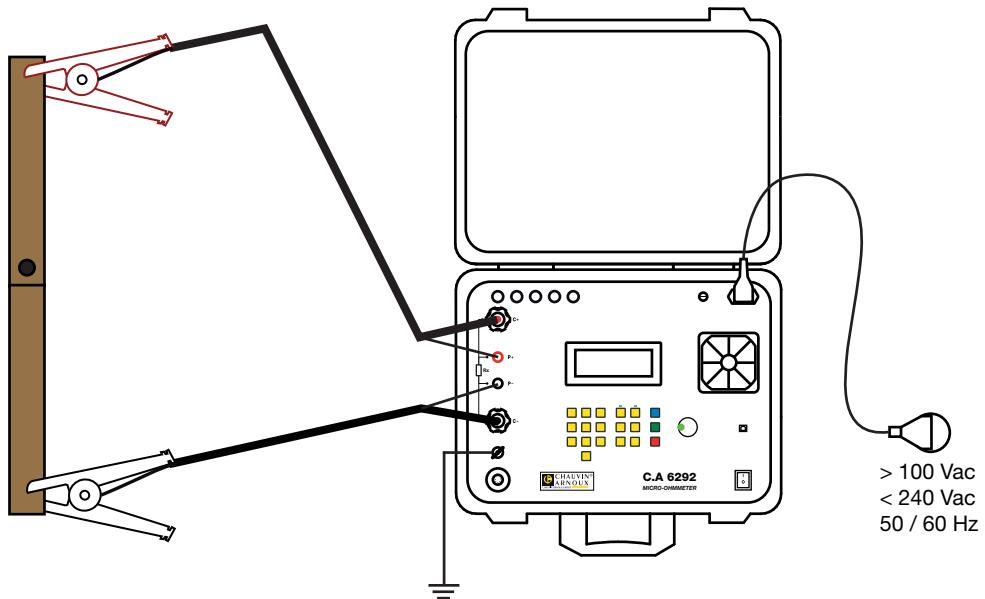
**i** Schrauben Sie die Klemmen fest zu, um die Kontaktwiderstände zu reduzieren und das Erhitzen zu begrenzen. Achten Sie darauf, dass die Leitungen ordnungsgemäß abgewickelt sind und keine Schleife legen.
