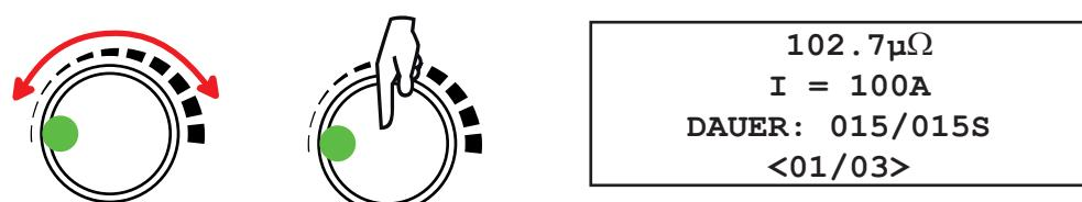
Es gibt drei Messergebnisse. Um durch diese Ergebnisse zu scrollen, drehen Sie den Drehschalter. Zum Verlassen drücken Sie die Taste **ESC**.
