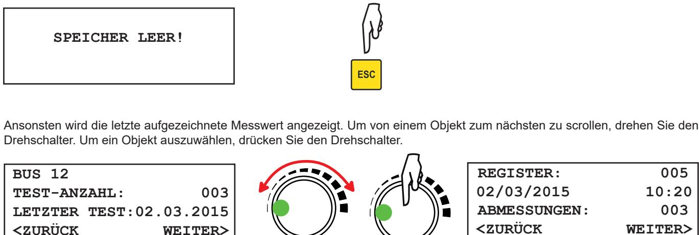
Um in dieser Aufzeichnung von einer Messung zur nächsten zu scrollen, drehen Sie den Drehschalter. Um eine Messung auszuwählen, drücken Sie den Drehschalter.
