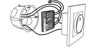
△ Achtung! Die so angeschlossene Steckdose unterstützt eine maximale Last von 2000W – 10A.
