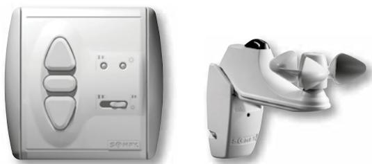
Automatische (wind- und helligkeitsabhängige) und manuelle Steuerung mehrerer Antriebe. Je Antrieb wird zusätzlich ein Smooove Uno IB+ Motoreinzelsteuergerät benötigt. Eine Steuerleitung (IB-Bus) verbindet das Zentralsteuergerät Soliris IB mit den Motoreinzelsteuergeräten.
