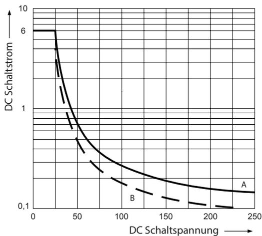
Reduktionsfaktor für die Ermittlung der maximalen Schaltleistung bei induktiver Last
