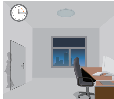
Der Sensor schaltet das Licht nach der Haltezeit automatisch aus, wenn keine Bewegung erkannt wird.
