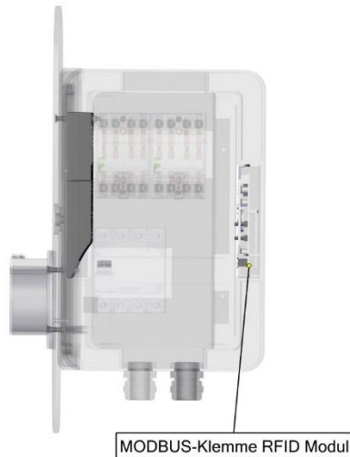
Abbildung 3 Anschluss des Modbuskabels
