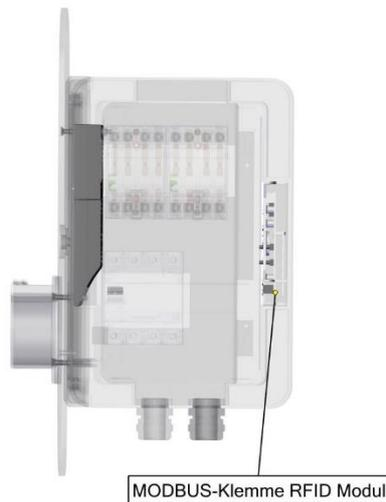
Abbildung 3 Anschluss des Modbuskabels
