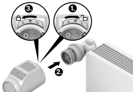
1. Sicherstellen, dass der Schieber am Heizkörperregler in der offenen Position ist.
