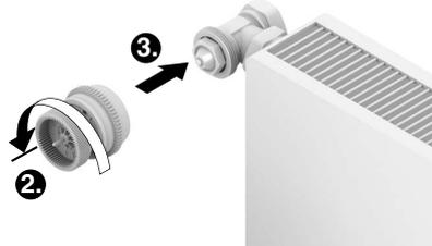
2. Stellrad des Ventilaufsatzes gegen den Uhrzeigersinn bis zum Anschlag drehen.
