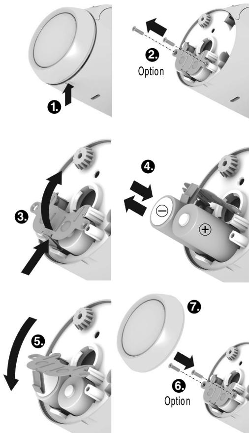
1. Stellrad abziehen. Dazu an der Kerbe an der Unterseite des Geräts ansetzen.
