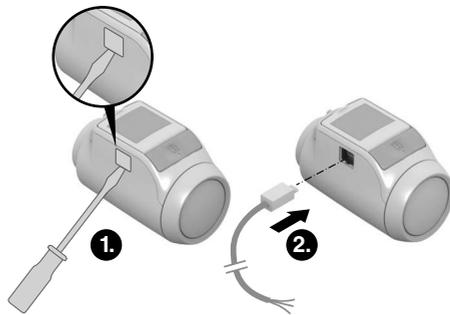
1. Seitliche Abdeckung am Heizkörperregler abnehmen.
