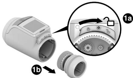
1. Ventilaufsatz vom Heizkörperregler trennen. Dazu den Schieber in Richtung
